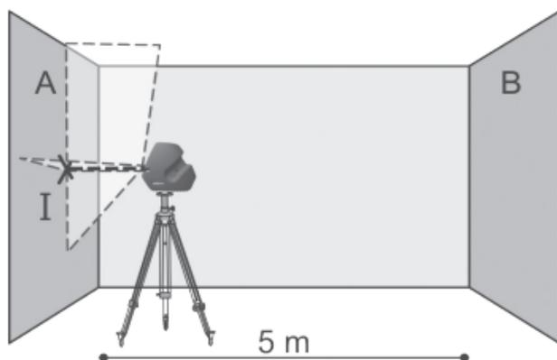
Поверните инструмент на 180°, дождитесь компенсирования и пометьте точку перекрещивания лазерных линий на противоположной стене В (точка II).
