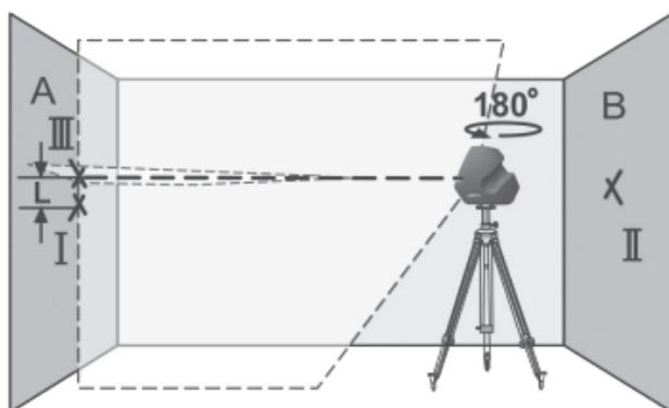
Разница L между обеими отмеченными точками I и III на стене A является действительным отклонением по высоте инструмента.
