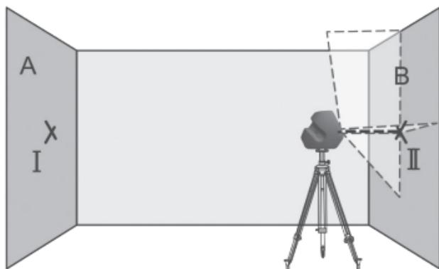
Поверните инструмент на 180°, не изменяя высоты. Направьте инструмент на стену A так, чтобы вертикальная лазерная линия проходила через уже отмеченную точку I. Выждать окончания компенсирования и пометить точку пересечения лазерных линий на стене A (точка III).
