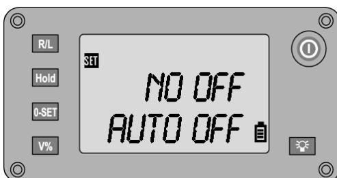
Включение/выключение функции автоматического отключения прибора
