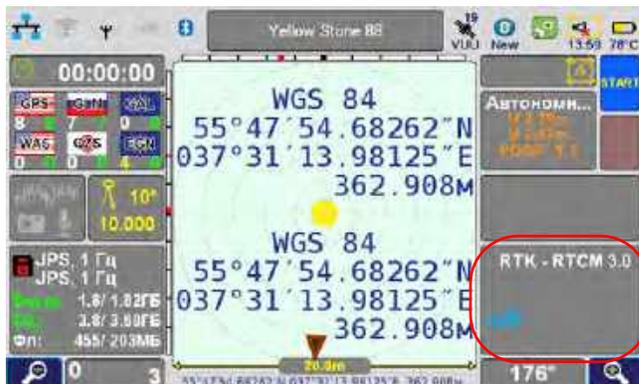
Рисунок 67. Экран съемки - работает базовая станция
