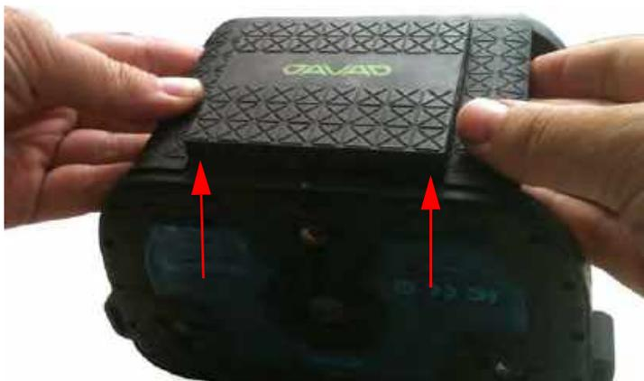
Рисунок 8. Выемка аккумуляторной батареи
