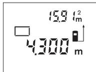
Після закінчення другого вимірювання прилад автоматично розраховує площу і показує результат. Останнє одиничне виміряне значення показується внизу на дисплеї, кінцевий результат знаходиться угорі.
