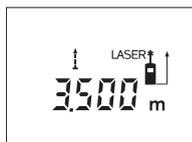
Stlačte tlačidlo Meranie **12**, aby ste spustili meranie. Merací prístroj pohybuje dotvedy, kým sa dole na displeji zobrazí požadovaná hodnota vzdialenosti.
