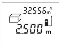
Po zakończeniu trzeciego pomiaru, powierzchnia zostanie automatycznie obliczona i ukazany wynik obliczeń. Wynik ostatniego pomiaru jednostkowego ukazany jest u dołu wyświetlacza, wynik końcowy u góry.
