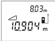
Pēc otrā mērījuma beigām tiek automātiski aprēķināts attālums **B**. Pēdējā atsevišķā mērījuma vērtība parādās uz displeja apakšējā indikatora, bet aprēķinātā attāluma **B** vērtība ir nolasāma uz displeja augšējā indikatora.
