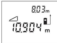
Nakon završenog drugog mjerenja automatski će se izračunati udaljenost **B**. Zadnja pojedinačna izmjerena vrijednost nalazi se dolje na displeju, a krajnji rezultat **B** gore.
