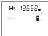
Lai uz displeja nolasi tu mērinstrumenta atmiņā ierakstīto vērtību, nospiediet atmiņas satura nolasišanas taustiņu **4**. Uz displeja parādās atmiņas satura nolasišanas indikators „M“. Ja uz displeja ir redzams atmiņas satura nolasišanas indikators „M“, tad, nospiežot pieskaitīšanas taustiņu **2**, atmiņas saturs divkāršojas, bet, nospiežot atņemšanas taustiņu **8**, atmiņas saturs kļūst vienāds ar nulli.
