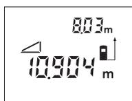
След приключване на второто измерване дължината на **B** се изчислява автоматично. Последно измерената дължина остава изобразена в долната част на дисплея, крайният резултат **B** – в горната.
