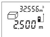
По окончании третьего измерения объем автоматически рассчитывается и высвечивается на дисплее. Последнее единичное измерение высвечивается на дисплее внизу, а конечный результат – сверху.
