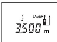
Pro spuštění procesu měření stlačte tlačítko měření **12**. Pohybuje měřicím přístrojem tak dlouho, až se dole na displeji zobrazí požadovaná hodnota vzdálenosti.
