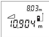
Після закінчення другого вимірювання відстань **B** розраховується автоматично. Останнє одиничне вимірне значення відображається внизу на дисплеї, кінцевий результат **B** відображається угорі.
