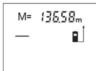
Stlačte tlačidlo na vyvolanie pamäte **4**, aby sa zobrazila hodnota, ktorá je uložená v pamäti. Na displeji sa zobrazí symbol pamäti „M=“. Keď sa na displeji zobrazí obsah pamäte „M=“, môžete ho stlačením príslovacieho tlačidla pamäte **2** zdvojnásobiť, resp. stlačením odpočítavacieho tlačidla pamäte **8** zredukovať na nulu (vynulovať).
