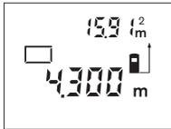
Pärast teise mõõtmise teostamist arvutatakse pindala automaatselt välja ja kuvatakse ekraanile. Viimase üksiku mõõtmise väärtust näidatakse ekraani alumises osas, lõpptulemust ülemises osas.
