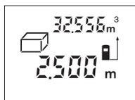
Pēc trešā mērījuma beigām tilpuma mērījuma rezultāts tiek automātiski aprēķināts un parādīts uz displeja. Pēdējā atsevišķā mērījuma rezultāts parādās uz displeja apakšējā indikatora, bet aprēķinātā tilpuma vērtība ir nolasāma uz displeja augšējā indikatora.
