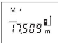
Lai ierakstītu mērinstrumenta atmiņā pašreizējo mērījuma rezultātu, kas iegūts garuma, laukuma vai tilpuma mērīšanas režīmā, nospiediet pieskaitīšanas taustiņu **2**. Ierakstot mērījuma rezultātu atmiņā, uz displeja parādās atmiņas satura indikators „M” un īslaicīgi kļūst redzams apzīmējums „+”.
