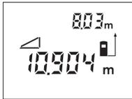
По завршување на второто мерење, растојанието **B** автоматски се пресметува. Последната поединечна вредност стои долу на екранот, а крајниот резултат **B** горе.
