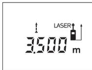
Pritisnite tipku mjerenja **12** za aktiviranje postupka mjerenja. Mjerni alat pomičite toliko dugo dok se dolje na displeju ne pokaže željena vrijednost udaljenosti.
