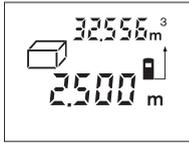
Після закінчення третього вимірювання прилад автоматично розраховує об'єм і показує результат. Останнє одиничне вимірне значення показується внизу на дисплеї, кінцевий результат знаходиться угорі.
