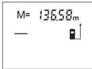
Pritisnite tipku za pozivanje memorije **4**, za pokazivanje vrijednosti koja se nalazi u memoriji. Na displeju se pojavljuje „**M=**“. Ako se na displeju pokazuje sadržaj memorije „**M=**“, tada ga pritiskom na tipku memorije za zbrajanje **2** možete podvostručiti, odnosno pritiskom na tipku memorije za oduzimanje **8** svesti na nulu.
