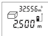
A harmadik mérés befejezése után a készülék automatikusan kiszámítja és kijelzi a térfogatot. Az utolsó egyedi mérés eredménye a kijelző alsó részén, a végeredmény pedig fent látható.
