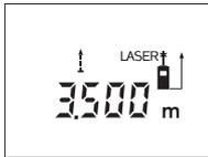
Lai uzsāktu mērīšanu, nospiediet mērīšanas taustiņu **12**. Pārvietojiet mērinstrumentu, līdz displeja apakšējā daļā parādās vēlams attāluma vērtība.
