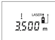
Чтобы начать процесс измерения, нажмите кнопку измерения **12**. Передвигайте измерительный инструмент, пока внизу на дисплее не отобразится желаемое расстояние.
