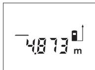
Stlačte tlačítko měření **12** jednou k zaměření a znovu pro změření.
