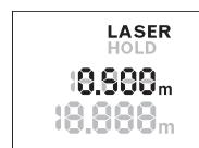
Ще раз натисніть на кнопку «HOLD» **2**, щоб знову увімкнути лазер. Надпис **LASER** мигає на дисплеї. У верхньому рядку відображається попередній результат вимірювання. В нижньому рядку відображається постійно актуалізований/ актуальній результат вимірювання.
