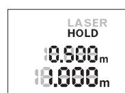
Знову натисніть на кнопку «HOLD» **2**, щоб ще раз зупинити вимірювання. Лазерний промінь вимикається, і на дисплей з'являється надпис **HOLD**. У верхньому рядку відображається попередній результат вимірювання. В нижньому рядку дисплея відображається, але більше не актуалізується актуальній результат вимірювання.
