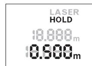
Натисніть на кнопку «HOLD» **2**, щоб зупинити вимірювання. Лазерний промінь вимикається, і на дисплей з'являється надпис **HOLD**. Активний результат вимірювання продовжує відображатися в нижньому рядку дисплея, але більше не актуалізується.
