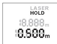
Wcisnąć przycisk „HOLD“ **2**, aby zatrzymać pomiar. Wiązka laserowa jest wyłączana, a wskaźnik **HOLD** pojawia się na wyświetlaczu. Aktualna wartość pomiarowa wyświetlana jest w dalszym ciągu w dolnym pasku wyświetlacza, ale nie jest stale aktualizowana.
