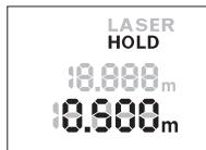
Mõõtmise peatamiseks vajutage „HOLD“-nupule **2**. Laserkiir lülitub välja ja näit **HOLD** ilmub ekraanile. Aktuaalset mõõtetulemust kuvatakse endisel ekraani alumisel real, kuid seda ei ajakohastata pidevalt.
