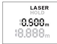
Wcisnąć przycisk „HOLD“ **2**, aby ponownie włączyć laser. Wskaźnik **LASER** migra na wyświetlaczu. W górnym pasku wyświetlna jest poprzednia wartość pomiarowa. W dolnym pasku wyświetlna jest aktualna/aktualizowana wartość pomiarowa.
