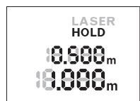
Pritisnite ponovno tipku „**HOLD** **2** kako biste ponovno zaustavili mjerjenje. Laserska zraka se isključuje i pokazatelj **HOLD** se pojavljuje na displeju. U gornjem retku se prikazuje pret-hodna mjerena vrijednost. U donjem retku se prikazuje aktualna mjerna vrijednost ali se više stalno ne aktualizira.
