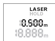
Снова нажмите на кнопку «HOLD» **2**, чтобы опять включить лазер. Надпись **LASER** мигает на дисплее. В верхней строке отображается предыдущий результат измерения. В нижней строке отображается постоянно актуализируемый/актуальный результат измерения.
