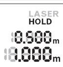
Mõõtmise veelkordseks peatamiseks vajutage uuesti „HOLD“-nupule **2**. Laserkiir lülitub välja ja näit **HOLD** ilmub ekraanile. Ülemisel real kuvatakse eelmist mõõtetulemust. Alumisel real kuvatakse aktuaalset mõõtetulemust, kuid seda ei ajakohastata pidevalt.
