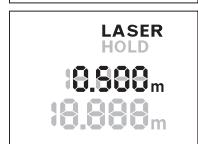
Pritisnite ponovno tipku „**HOLD** **2** za ponovno uključivanje lasera. Pokazatelj **LASER** treperi na displeju. U gornjem retku se prikazuje pret-hodna mjerena vrijednost. U donjem retku se stalno prikazuje aktualizirana/aktualna mjerna vrijednost.
