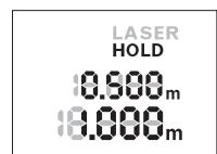
Če želite merjenje začasno prekiniti, pritisnite tipko „HOLD“ **2**. Laserski žarek se izključi in na prikazovalniku se prikaže **HOLD**. Trenutna izmerjena vrednost je še naprej prikazana v spodnji vrstici prikazovalnika, vendar se več ne posodablja.
