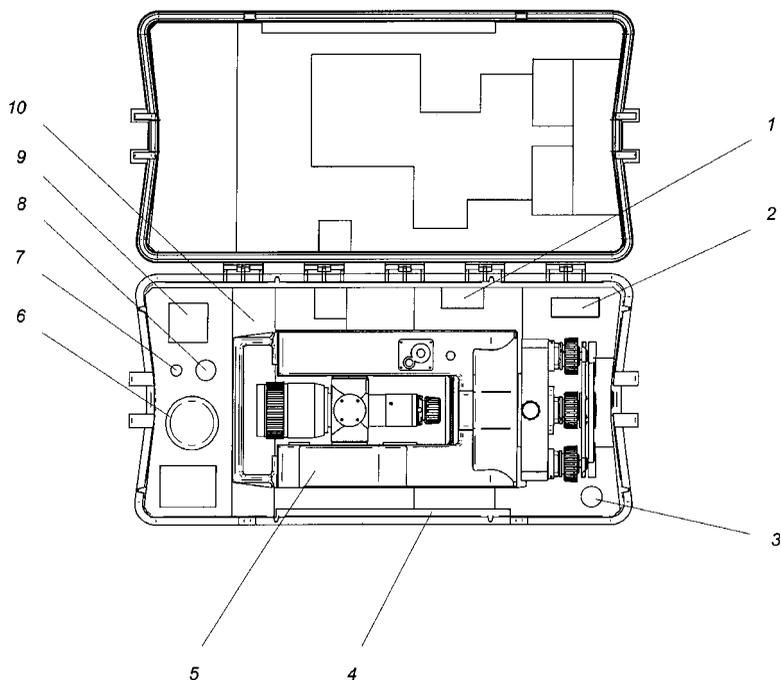
1 – инструмент и принадлежности (отвертки, шпильки, ключ юстировочный и масленка) в пакете; 2 – насадка на объектив\*; 3 – вешка\*; 4 – паспорт; 5 – теодолит; 6 – бленда\*; 7 – окулярная насадка на микроскоп\*; 8 – окулярная насадка на трубу\*; 9 – ориентир-буссоль\*; 10 – чехол\*
