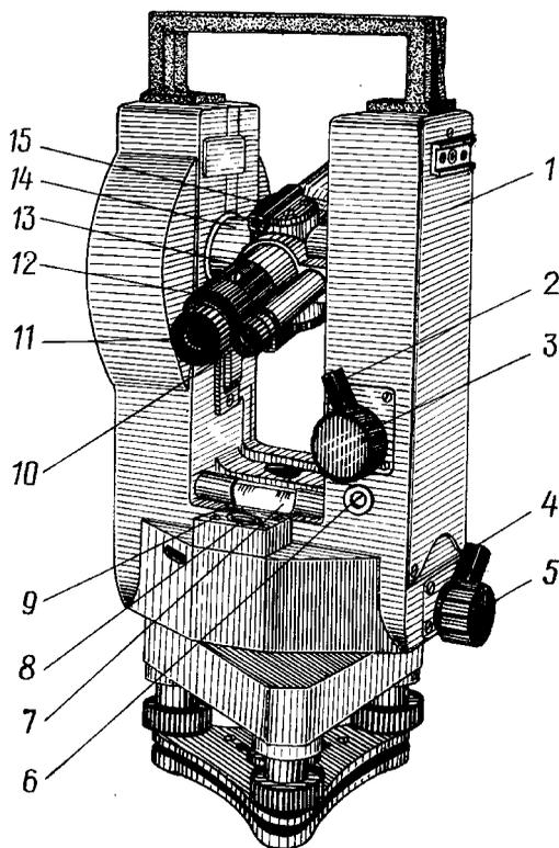
1 – боковая крышка; 2, 4 – закрепительные винты; 3, 5 – наводящие винты; 6 – юстировочный винт цилиндрического уровня; 7 — цилиндрический уровень; 8 – круглый уровень; 9 – юстировочный винт круглого уровня; 10 – окуляр микроскопа; 11 – окуляр зрительной трубы; 12 – колпачок; 13 – кремальера; 14 – горизонтальная ось; 15 – визир
