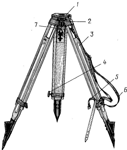
1 – головка; 2 – болт; 3 – ножка; 4 – винт; 5, 6 – ремни; 7 – винт становой
