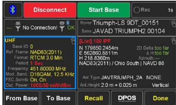
чи, увеличивается потребление батареи радиомодема, а также повышенное тепловыделение внутри радио. При работе с модемом HPT435BT вам может понадобиться специальный модемный вентилятор при мощности сигнала более 4 Вт и в зависимости от температуры окружающей среды. Теперь UpSampling данных предпочтительнее поправок в 5 Гц, поскольку это увеличивает срок службы батареи и диапазон радиостанций и уменьшает выделение тепла модемом.
