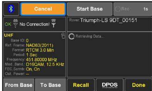
Нажатие на панель слева открывает экран для настройки параметров радио. Формат «RTCM 3.0 Min» должен использоваться, чтобы уменьшить размер передаваемых по радио данных.
