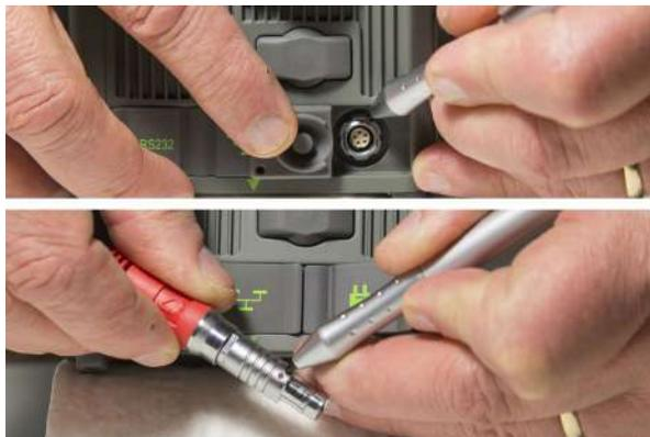
Некоторые кабели и их разъемы, используемые для зарядки оборудования, могут быть вам незнакомы. Разъемы типа ODU тлично подходят для широкого спектра задач подачи питания, коммуникаций и приложений для передачи данных, требующих высокоточного и надежного решения.
