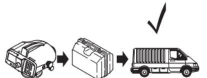
Не перевозите незакрепленный инструмент в транспорте. Удары и вибрация могут привести к повреждению инструмента. Всегда перевозите инструмент, упакованным в кейс.
